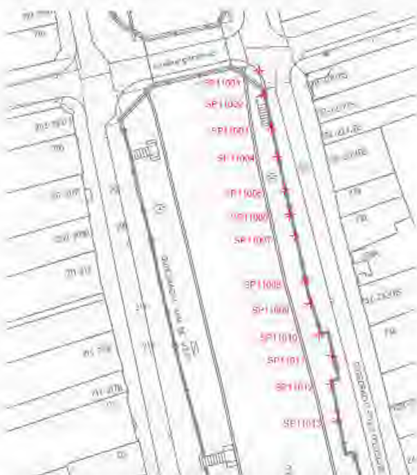
Figuur 2; locaties prisma's aan werfmuur rak 11 oost noordzijde
